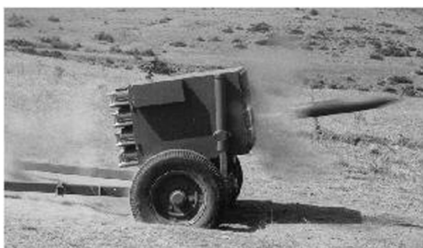
Рис. 5. 32-трубная 128-мм РСЗО М-63
