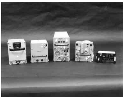
Рис. 3. Станция AN/APX-76 системы опознавания IFF Mk12
