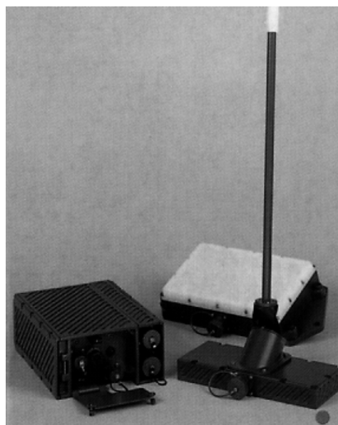
Рис. 4. Французский комплект аппаратуры опознавания, предназначенный для размещения на наземных объектах
